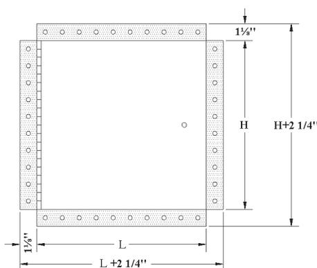
L'ouverture dans le mur = dimensions de la porte + 1/4 ou + 6mm
