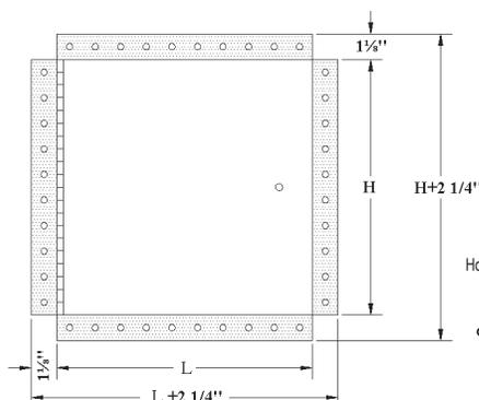
L'ouverture dans le mur = dimensions de la porte + 1/4 ou + 6mm
